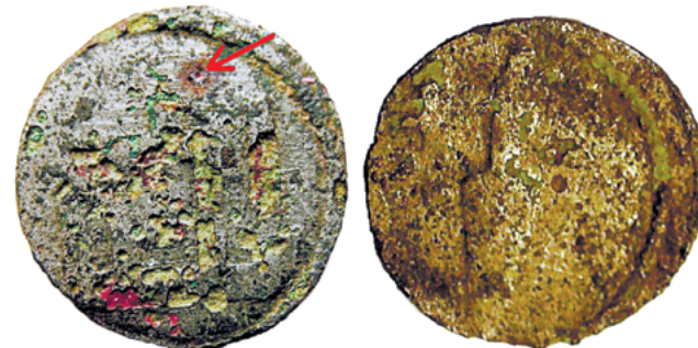
Стрэлкай пазначана кропка ад выстралу мікраінтэрферометра Лініка МІИ-4
